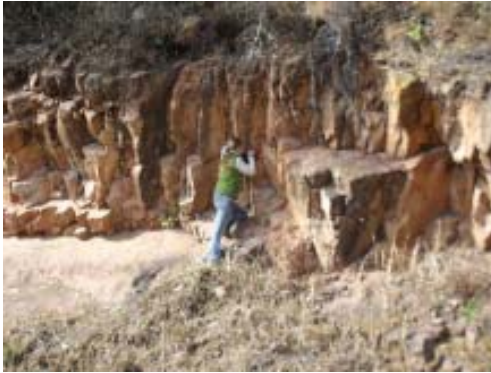
Fotos1 y 2. Macizo rocoso conformado por cuarcitas. Detalle del sistema de diaclasamiento.
