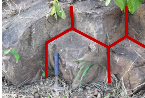
Fotos1 y 2. Macizo rocoso conformado por cuarcitas. Detalle del sistema de diaclasamiento.
