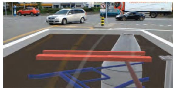
Figura 3. De arriba hacia abajo: Visualización de las líneas de instalaciones subterráneas con RPT de las zonas escaneadas en Singapur; unión de maqueta digital de la ciudad con nube con el gemelo digital de las instalaciones existentes en la ciudad de Singapur; visualización del gemelo digital de las instalaciones subterráneas con realidad mixta. Fuentes: Van Son (2018) y CNA (2019)
