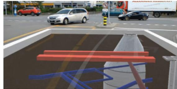
Figura 3. De arriba hacia abajo: Visualización de las líneas de instalaciones subterráneas con RPT de las zonas escaneadas en Singapur; unión de maqueta digital de la ciudad con nube con el gemelo digital de las instalaciones existentes en la ciudad de Singapur; visualización del gemelo digital de las instalaciones subterráneas con realidad mixta. Fuentes: Van Son (2018) y CNA (2019)
